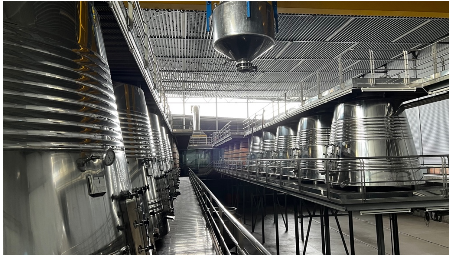
Figura 2.3 – Depósitos de fermentación de acero inoxidable con sistema de control de temperatura. Este equipamiento permite una fermentación más homogénea y eficiente.
