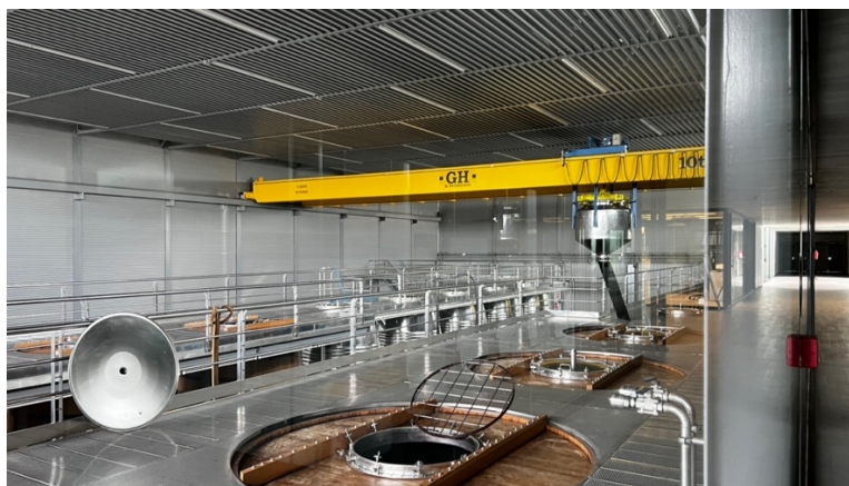
Figura 2.13 – Sistema de remontado por gravedad, compuesto por un depósito móvil suspendido en un puente grúa. Permite la recirculación del mosto sobre el sombrero de hollejos sin necesidad de bombeo, optimizando la extracción de compuestos fenólicos de manera controlada.
