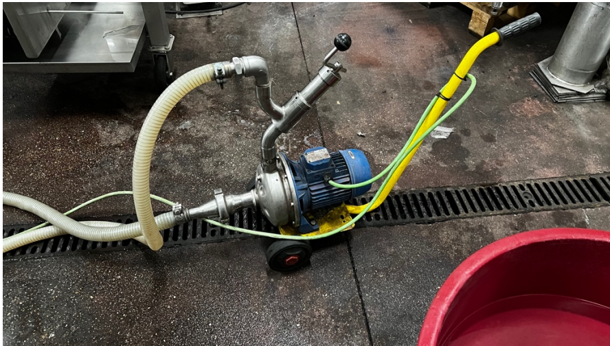
Figura 3.3 – Bomba de trasiego móvil utilizada para la transferencia de líquidos entre depósitos durante la vinificación.
