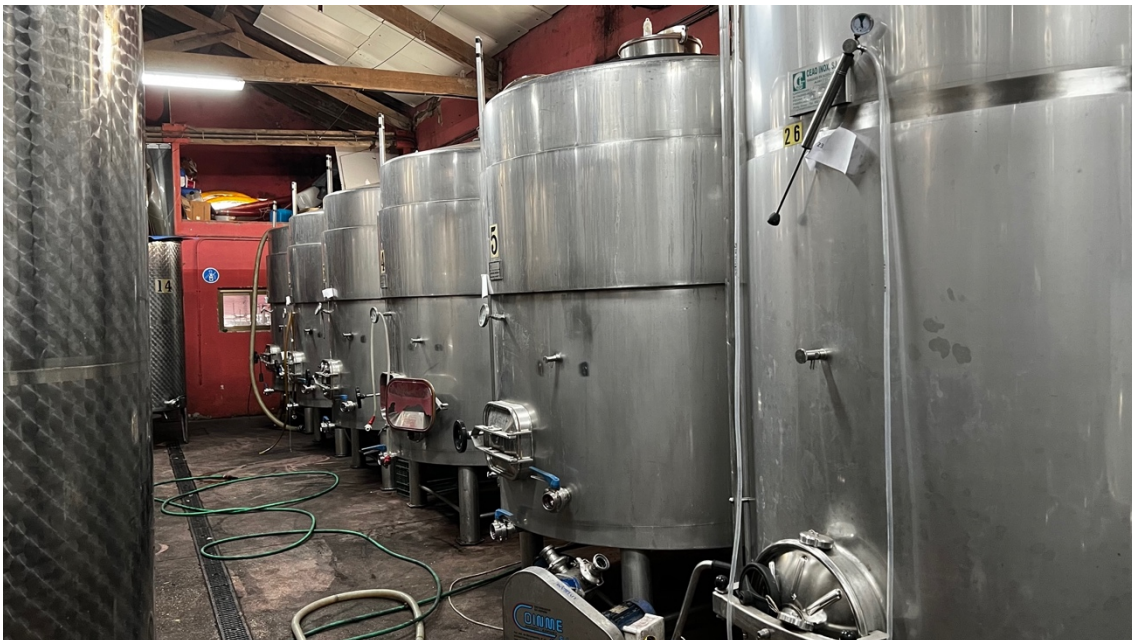
Figura 3.10 – Línea de depósitos de acero inoxidable, donde se lleva a cabo la fermentación alcohólica con control de temperatura.
