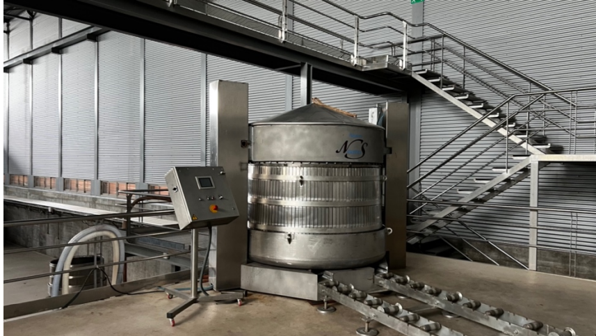
Figura 2.12 – Prensa neumática de acero inoxidable utilizada para la extracción controlada del mosto mediante un sistema de membrana de aire, optimizando el rendimiento y la calidad del vino.
