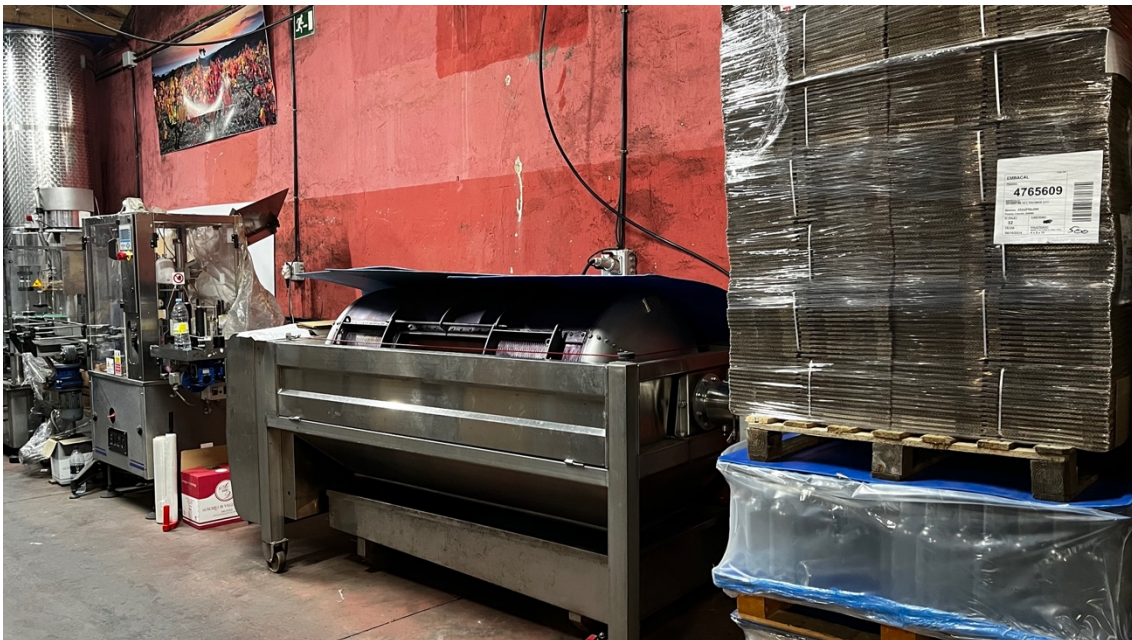
Figura 3.2 – Prensa neumática horizontal en Bodega Señorío de Valdesneros, utilizada para la extracción controlada del mosto mediante presión de aire, optimizando la calidad del vino.
