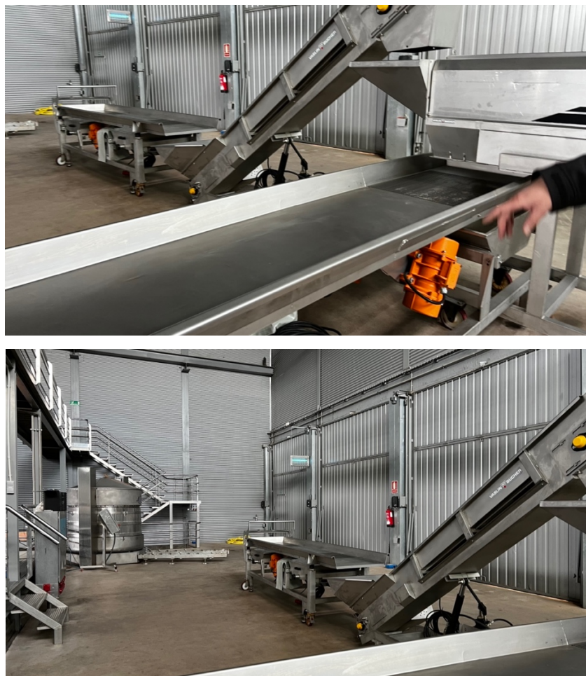
Figura 2.2 – Zona de recepción de uva. Se observa la tolva de recepción, la mesa de selección y la cinta transportadora utilizada en el proceso inicial de vinificación.
