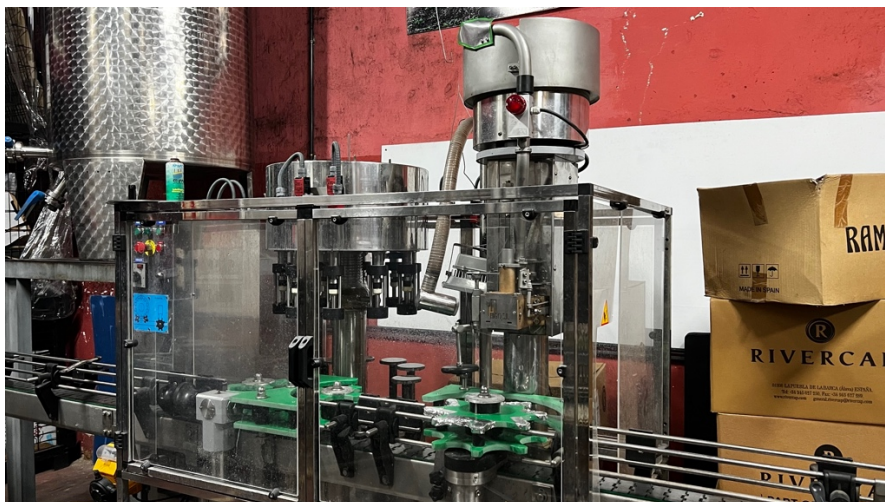
Figura 3.6 – Detalle del sistema de embotellado, con componentes automatizados para el llenado y sellado de botellas.
