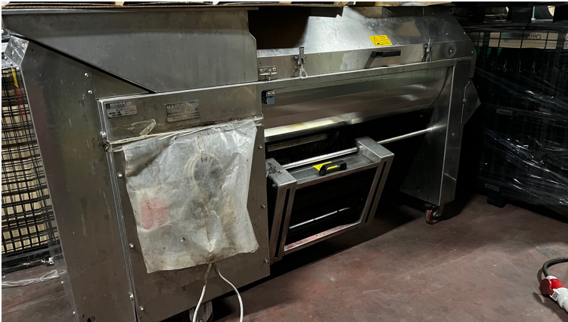
Figura 3.9 – Despalilladora en Bodega Señorío de Valdesneros, utilizada para separar los granos de uva del raspón antes de la fermentación.
