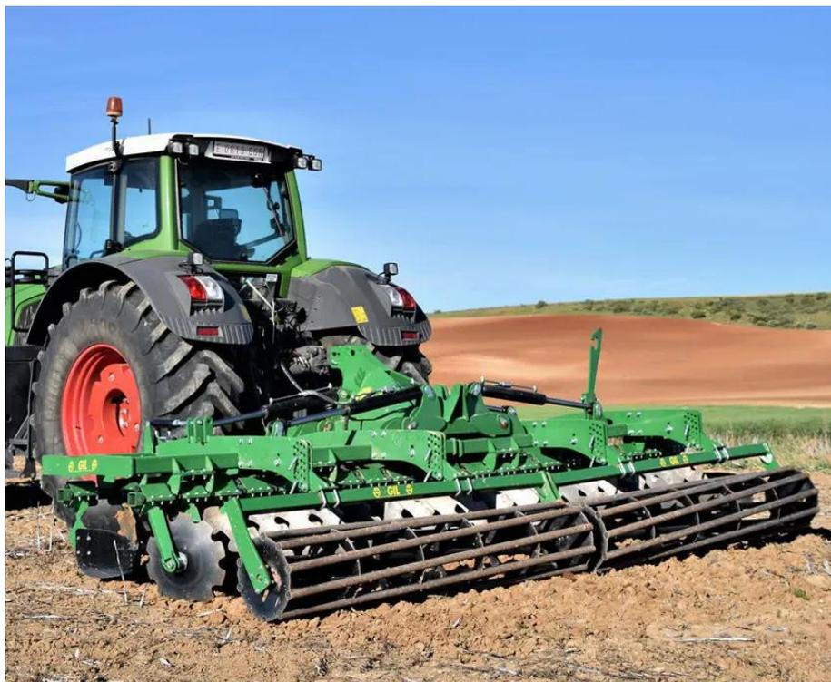
Ilustración 3. Grada de discos remolcada GR series. Fuente: www.agriexpo.online.es
