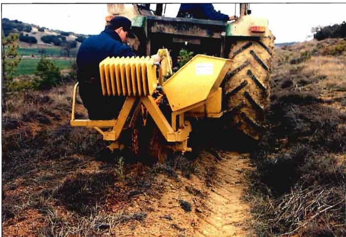
*Ilustración 8. Plantadora acoplada a tractor agrícola. Fuente: Gómez Mampaso, V. (1995). La maquinaria en los trabajos de repoblación forestal.*
