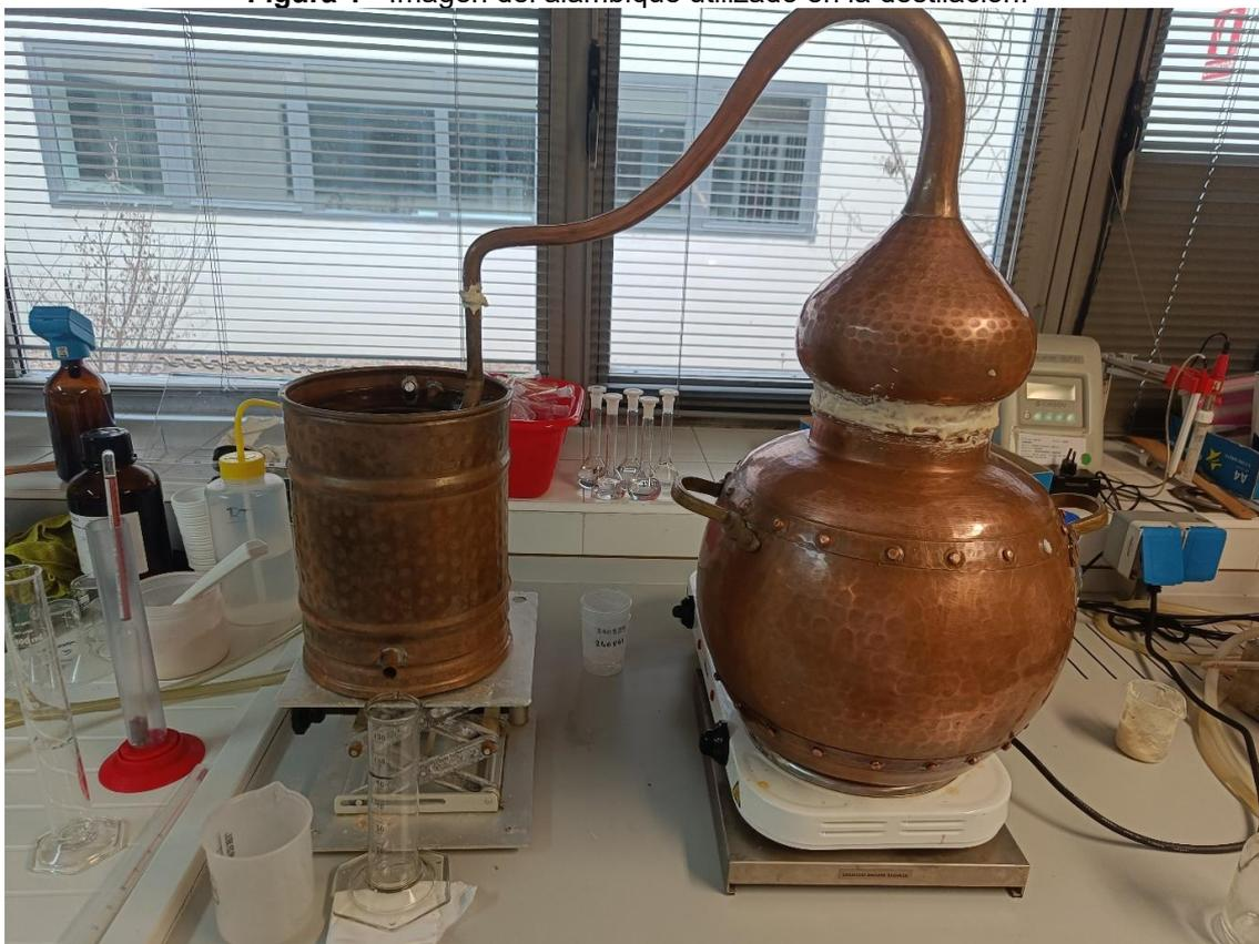
Figura 2 - Imagen del Clevenger utilizado en la destilación.
