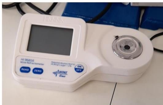
Figura 12: Refractómetro electrónico
