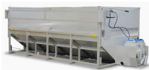
de la que se encuentra el remolque. Los racimos, una vez en la tolva, avanzan paralelamente al eje del sin fin, hasta salir por la boca de apertura, la cual desemboca en una cinta elevadora que transporta la uva hasta la despalilladora.
