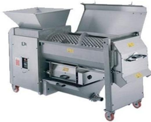
Figura 4. Despalilladora – Estrujadora
