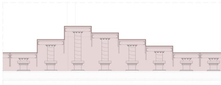
*Ilustración 24: Detalle sección Spiralift*
