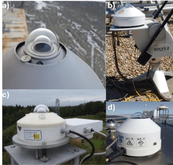
**Figura 2.7:** Piranómetros empleados para la medidas de irradiancia global horizontal: a) Modelo CMP-11, b) Modelo CM-21 (sobre el seguidor solar SOLYS-2 de la misma casa) y c) Modelo CM-22; los tres del fabricante *Kipp&Zonen*. d) Modelo EKO-MS802F de *EKO Instruments CO., LTD*.
