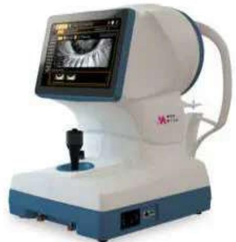
Concretamente el dispositivo MYAH proyecta 24 anillos concéntricos de luz (Figura 2) sobre la superficie anterior de la córnea que actúa como un espejo convexo, por lo tanto, el reflejo es capturado por cámaras y procesado punto a punto por un software calculando el perfil geométrico correspondiente.
