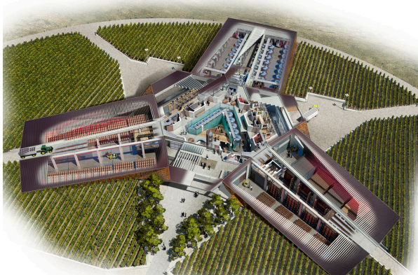
Figura 4.9. Axonometría explotada de la bodega
