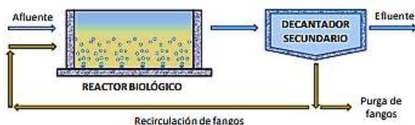
Ilustración 3 Aireaciones prolongadas Fuente: Confederación Hidrográfica del Duero (2019)
