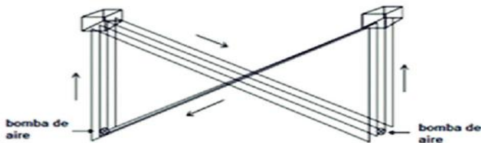
Figura 8: Esquema de un fotobiorreactor de columna de burbujeo conectado en configuración cruzada, operado por bombas de aire para la circulación del cultivo, Fuente: Autor con inspiración de Ramírez et al., Queiroz Zepka y Eduardo Jacob.
