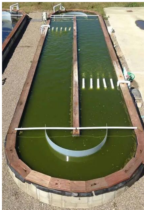
Figura 5: Esquema de un fotobiorreactor abierto tipo raceway con diseño serpenteante y rueda de paletas para agitación, Fuente: Adaptado de Ben-Amotz, A., National Institute of Oceanography (s.f.).
