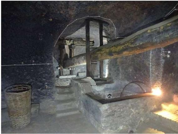
**Fig.14.** Contrapeso de la viga de lagar en la bodega SRH\_B60
