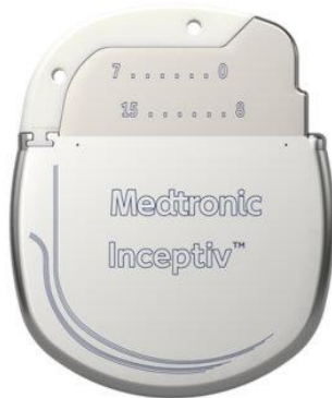
Figura 1. Neuroestimulador medular implantable de marca Medtronic, modelo Inceptiv. Imagen de Medtronic ® 2024
