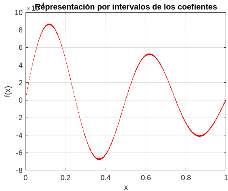
Figura 4.3: Representación de los coeficientes c_J de la función f(x) = e^{-x} \sin(4\pi x) en el intervalo [0, 1] con J = 10 obtenidos a través del algoritmo de descomposición y posteriormente del algoritmo de reconstrucción.
