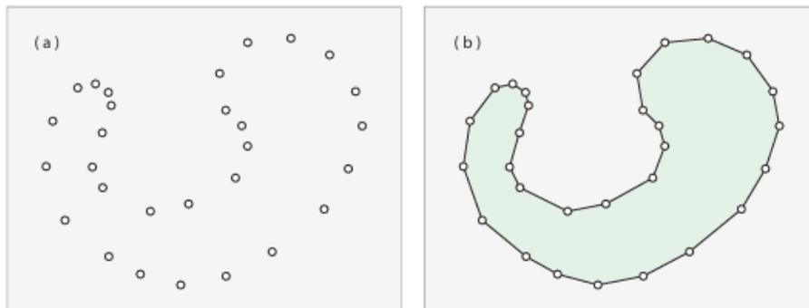
Figura 4.4: (a) Un conjunto de muestra de la curva de la Figura 4.3, junto con (b) una reconstrucción poligonal correcta de la curva a partir de la muestra.
