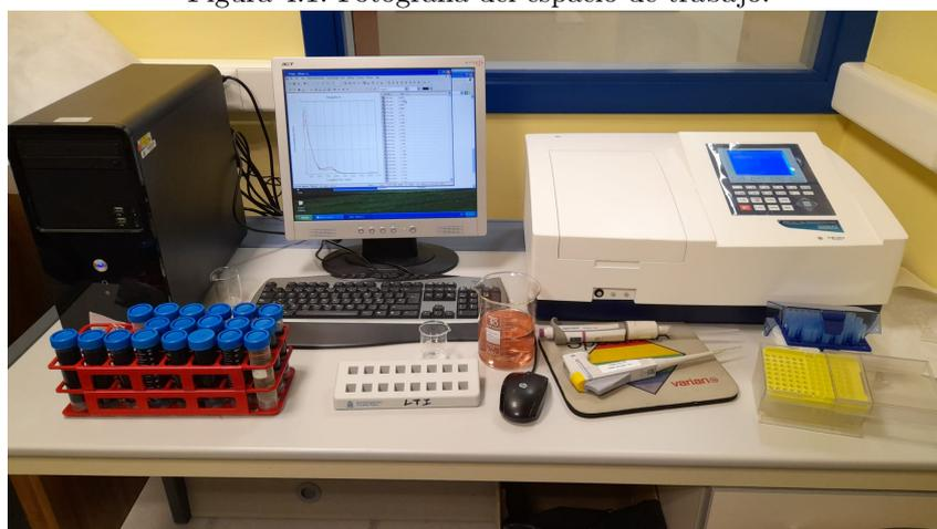
En la Figura 4.1 se puede ver la mesa del laboratorio donde se tomaron los espectro de absorción de las muestras de vino así como estas almacenadas en tubos y los materiales utilizados. Junto al ordenador podemos ver el espectrómetro utilizado, el cual describiremos más adelante y, en pantalla, un espectro de absorción de uno de los vinos tintos.
