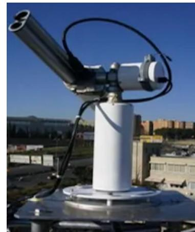
Figura 9: CIMEL CE318, realizando medidas de la radiancia del cielo.
