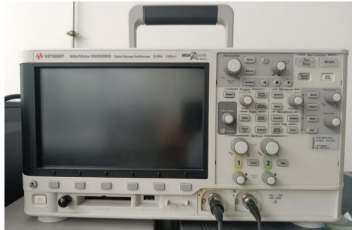
Figura 15: Fotografía del osciloscopio Agilent DSO-x 2002A utilizado para la visualización y análisis de la señal en distintas etapas del circuito.
