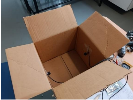
Figura 18: Primer montaje para la caracterización del ruido de fase del interferómetro. (a) Transductores fijados con cinta adhesiva en las paredes de la caja. (b) Caja cerrada para aislar el sistema del entorno.
