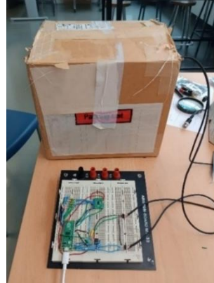
Figura 18: Primer montaje para la caracterización del ruido de fase del interferómetro. (a) Transductores fijados con cinta adhesiva en las paredes de la caja. (b) Caja cerrada para aislar el sistema del entorno.
