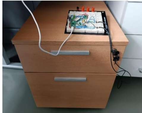
Figura 19: Montaje experimental para la caracterización del ruido de fase del interferómetro. (a) Transductores fijados sobre la base metálica. (b) Cajón cerrado para aislar el sistema del entorno.
