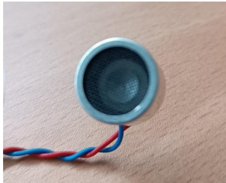
Figura 8: Fotografía del transductor ultrasónico TCT40-16 utilizado en el interferómetro.
