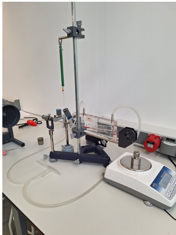
Figura 2.7: Dispositivo de medida de fuerzas de arrastre.
