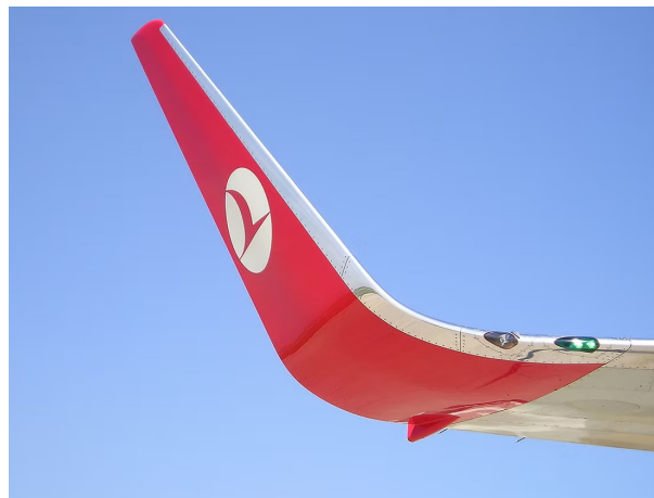
Figura 3.10: Winglet de una aeronave. Adaptado de [13].
