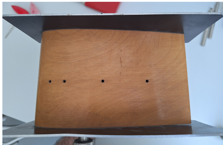
Figura 2.10: Orificios perforados en la superficie del ala gruesa.
