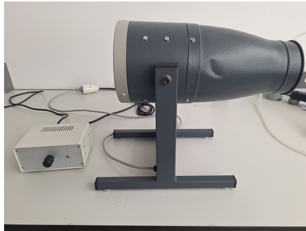
Figura 2.1: Potenciómetro y generador de flujo de aire metálico.
