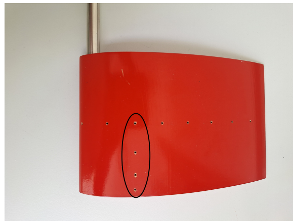
Figura 2.12: Orificios transversales para el estudio de los efectos de borde.
