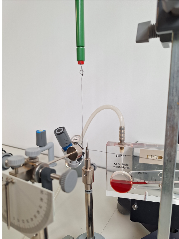
Figura 2.4: Alineación de la varilla apuntada con la balanza.
