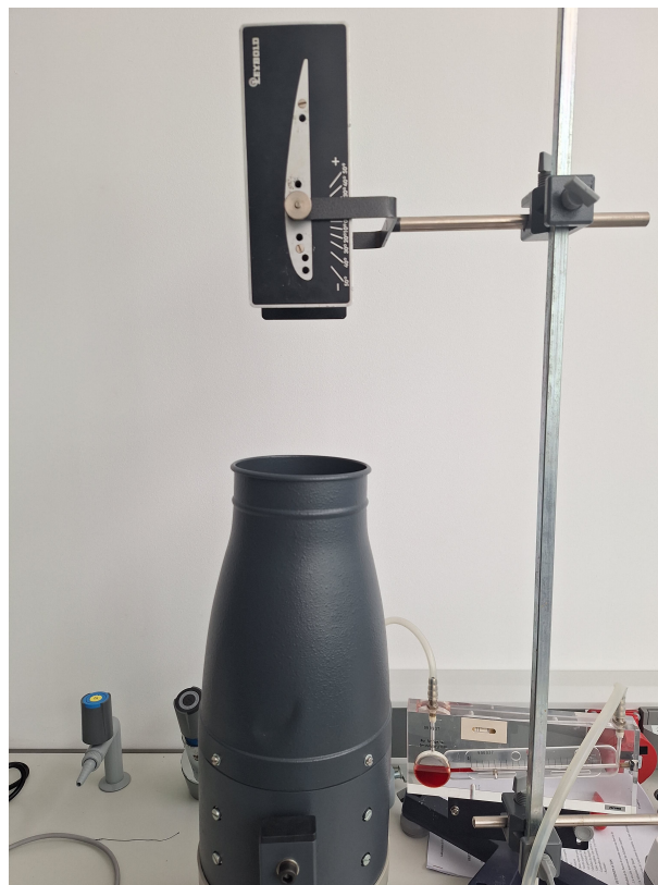
Figura 2.8: Dispositivo experimental para medir el perfil de presiones.
