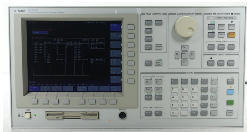
Figura 16: Analizador de semiconductores Hewlett Packard 4155B Semiconductor Parameter Analyzer utilizado en la caracterización de las muestras.
