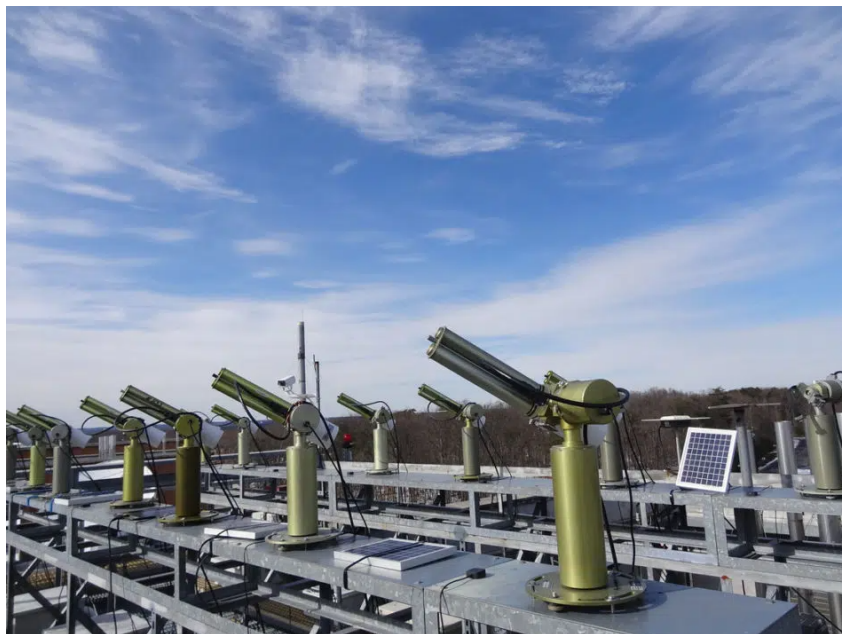
Figura 4: Imagen del radiómetro CE318-T obtenido en la página web www.cimel.fr/solutions/ce318-t/
