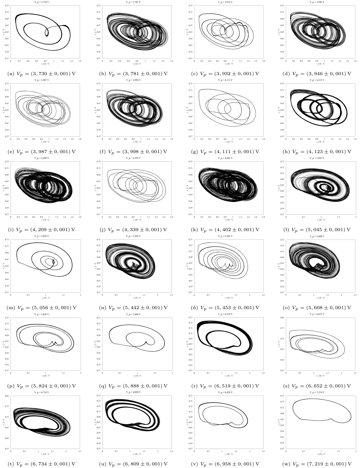
Figura B.1: Barrido del voltaje de alimentación V_p como parámetro: representación del voltaje v_2 (eje y) frente al voltaje v_{CE} (eje x), medidos con el osciloscopio, para distintos valores del parámetro, con V_+ = 529 \text{ mV} .
