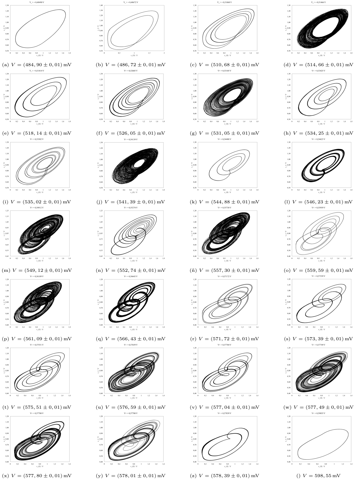
Figura 3.9: Barrido del parámetro V_+ : representación del voltaje v_1 (eje y) frente al voltaje v_{CE} (eje x), medidos con el osciloscopio, para distintos valores del parámetro.
