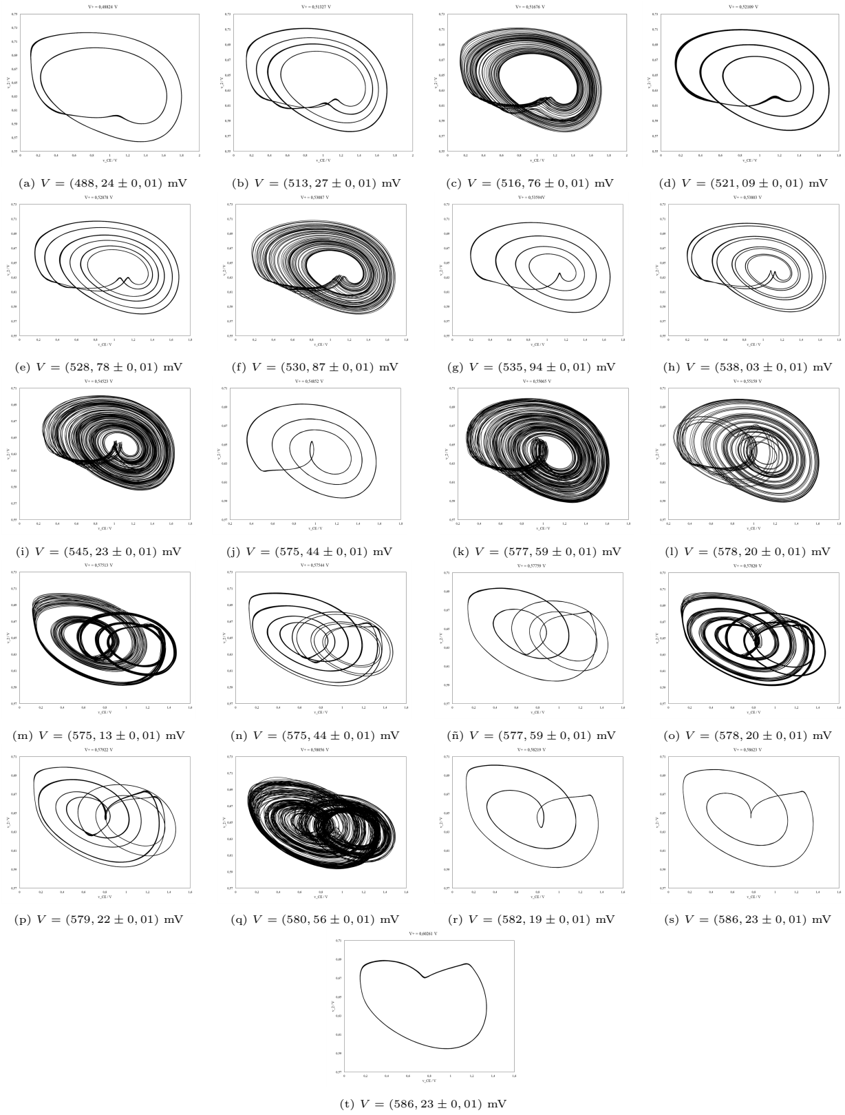
Figura 3.8: Barrido del parámetro V_+ : representación del voltaje v_2 (eje y) frente al voltaje v_{CE} (eje x), medidos con el osciloscopio, para distintos valores del parámetro.
