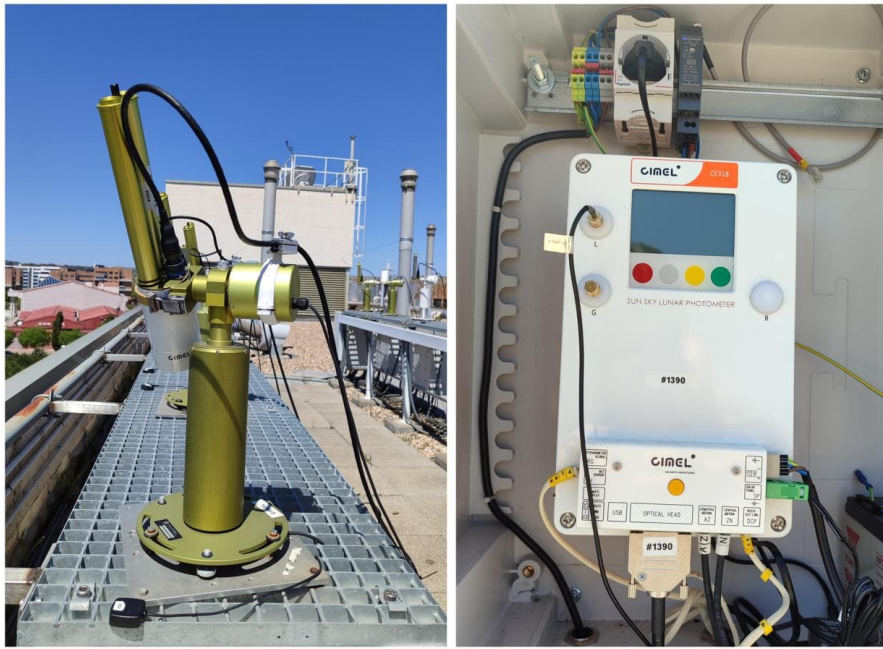
Figura 2.1: En la parte izquierda de la imagen se encuentra el fotómetro CE318 midiendo en la plataforma de medidas del GOA-UVa situada en la terraza de la Facultad de Ciencias de Valladolid (España). En la parte derecha se puede ver la caja de control del fotómetro.
