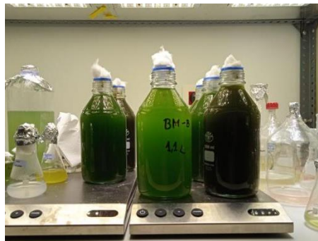
Figura 6. Fotobiorreactores bajo luz artificial que simula la luz solar en el espectro del visible.
