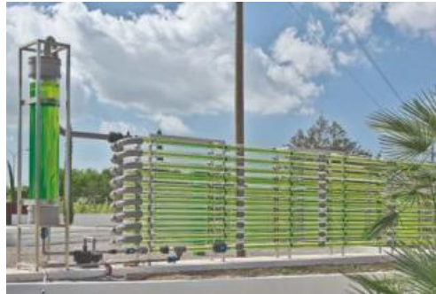
Figura 1. Fotobiorreactor tubular en el Parque Botánico Biotecnológico de Ibiza para la producción de microalgas.
