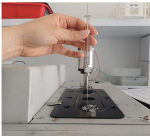
Figura 5. Jeringa de muestreo para la determinación de la composición del espacio de cabeza de los biorreactores de biodegradabilidad
