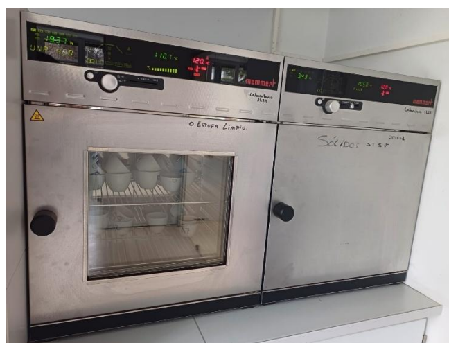
Figura 9. Estufa utilizada para la determinación de la concentración de sólidos totales
