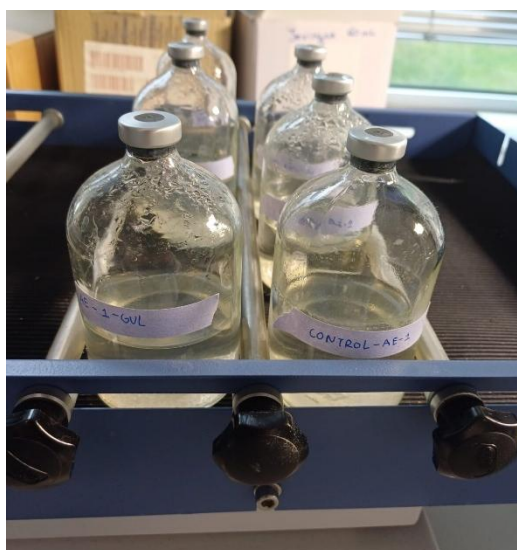
Figura 7. Incubador orbital empleado en el ensayo aeróbico
