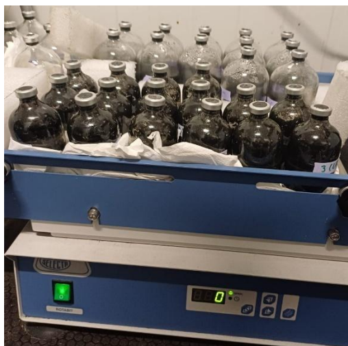
Figura 4. Incubador orbital empleado en el ensayo anaeróbico
