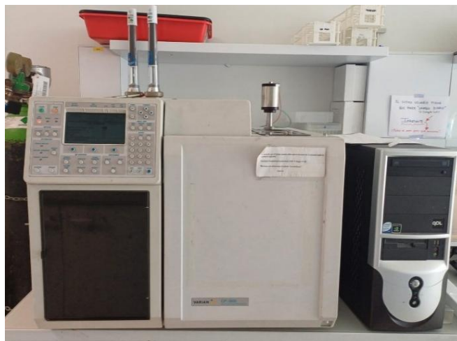
Figura 11. Cromatógrafo de gases equipado con detector de conductividad térmica
