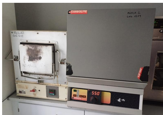
Figura 10. Mufla utilizada para la determinación de la concentración de sólidos volátiles
