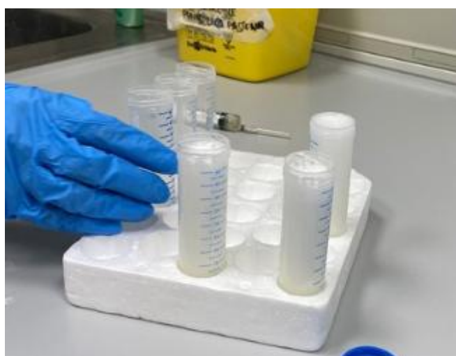
Figura 16. Tubos de ensayo con la mezcla del material y la solución homogeneizante, previa a su centrifugación.
