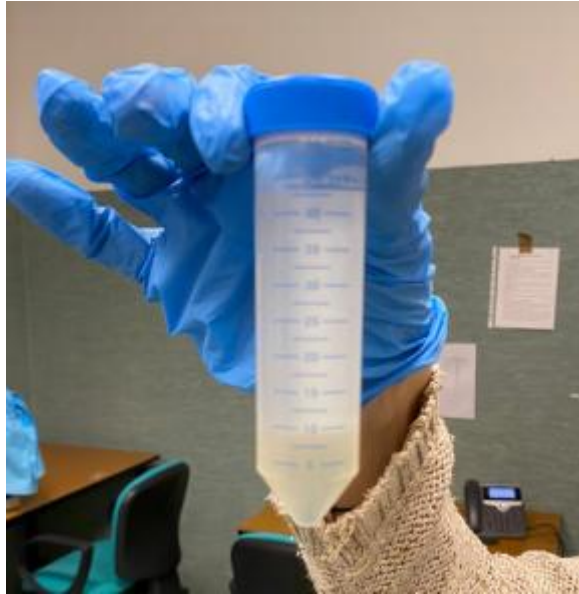
Figura 17. Tubo de ensayo donde se muestra el exceso de \text{CaCl}_2 que no se ha gelificado tras la centrifugación y al fondo del mismo la gelatina obtenida.
