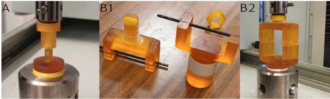
Figura 22. A. Pieza obtenida para los ensayos de compresión confinada colocada en la MTS. B1. Pieza obtenida para los ensayos de tracción. B2. Pieza obtenida para los ensayos de tracción colocada en la MTS.
