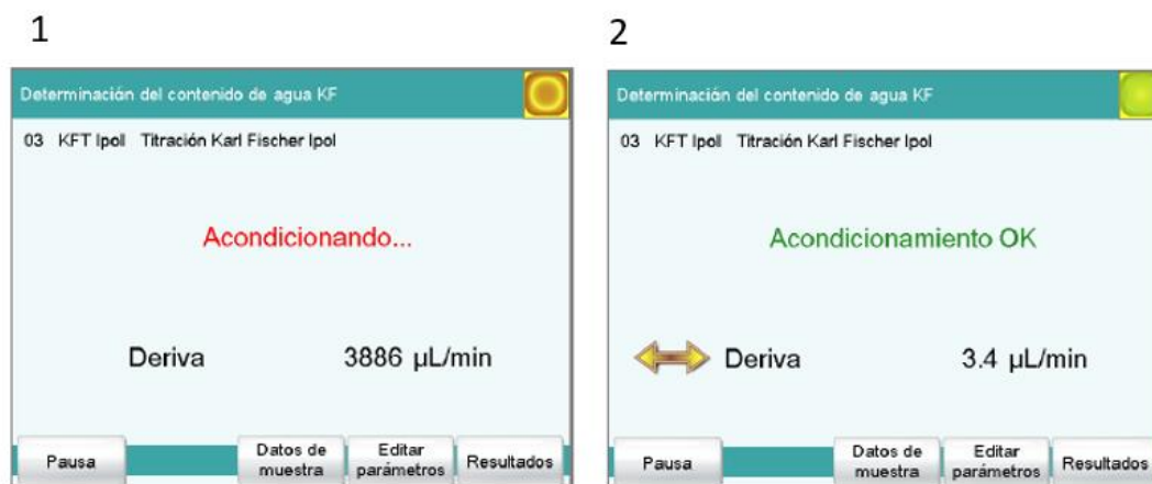
Figura 12: 1) Acondicionamiento no OK; 2) Acondicionamiento OK. Imagen obtenida de 14
