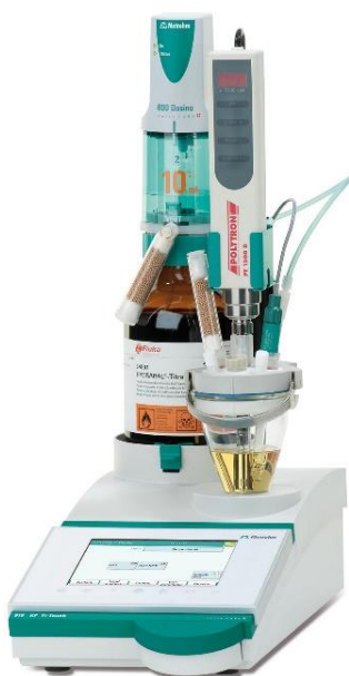
Figura 11: Equipo Karl-Fischer 915 KF Ti-Touch 14
