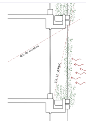
Figura 54. Pared vegetal. Elaboración propia
