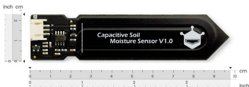
Figura 58 Sensor de humedad del suelo SKU SEN0193. Dimensiones y vista superior de la PCB. [8]
