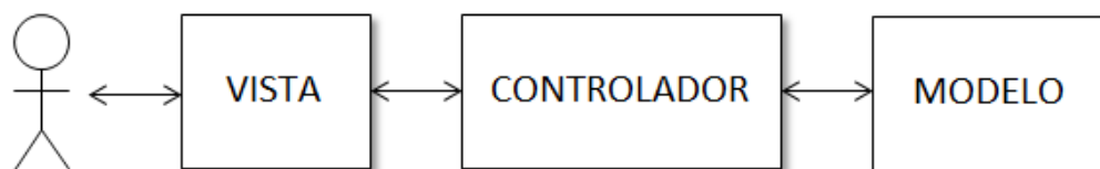
Figura 5.1: Esquema del patrón MVC
