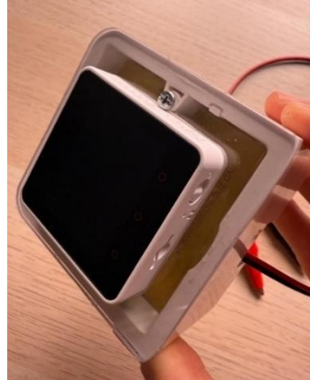
Figura 35. M5Stack-Core2 y PCB introducidos en la caja de mecanismos
