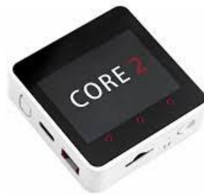
Figura 6. Módulo de desarrollo M5Stack-Core2
