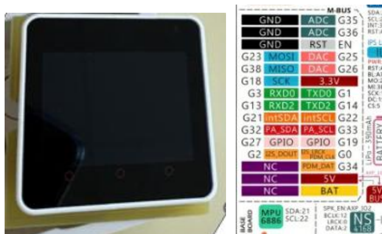
Figura 33. M5Stack introducido en la placa a través del bus de direcciones mostrado en la imagen
