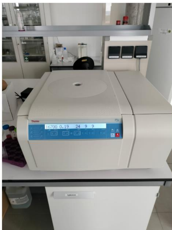
Figura 3: Centrífuga con la que se realizaron el lavado y jamming de los microgeles
