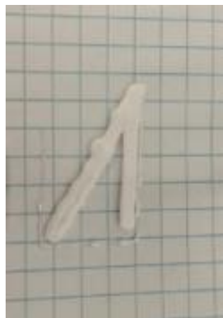
Figura 18: Diseño de una sola capa impreso con crema Nivea con una flow speed de 1.0 mm/s, una infill speed de 1,5 mm/s, una layer height de 0,3 mm, una bed temperatura de 25°C, una travel speed de 99 mm/s y un diámetro de la aguja de 0,25 mm/s.
