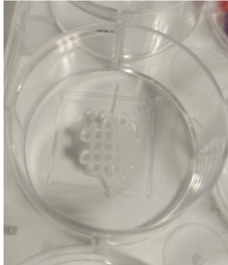
Figura 20: Diseño de 20 capas imprimido con crema Nivea sobre un pocillo tras la optimización final de parámetros, que son: flow speed de 0,1mm/s, una infill speed de 1,3 mm/s, una layer height de 0,15 mm, una bed temperatura de 25°C, una travel speed de 99 mm/s y un diámetro de la aguja de 0,25 mm/s.
