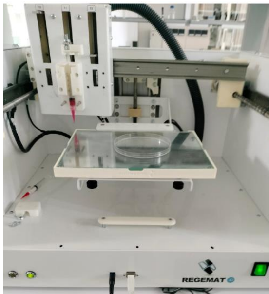
Figura 5: Imagen de la impresora 3D Regemat con la jeringa ya montada, que contiene los microgeles ya preparados para imprimir
