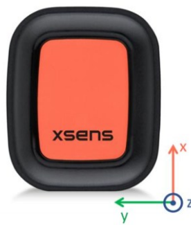
Figura 7. Sensor Xsens DOT y sistema de referencia.
