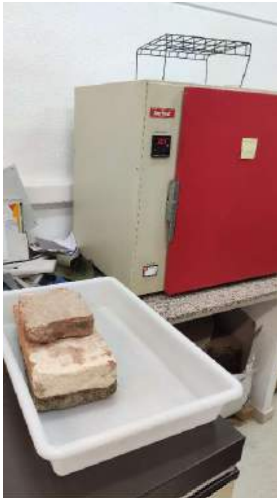
Fig. 138. Fotografía en el laboratorio de la ETSAVA, con la estufa ventilada a 103 ° C empleada para el secado de las tres probetas de ladrillo recogidas. Imagen del autor.
