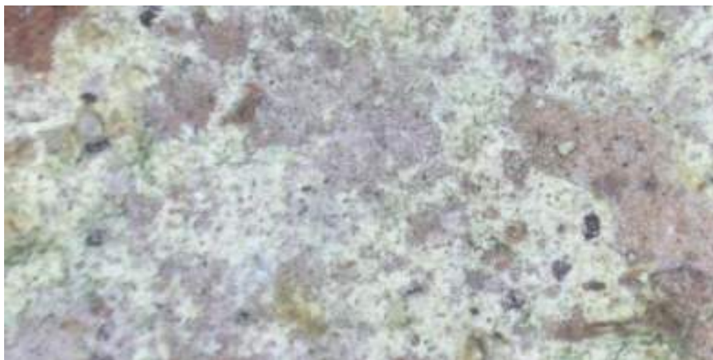
Fig. 118. Microfotografía del ladrillo 01 (sales) / aumento (x 0,75). Imagen del autor.
