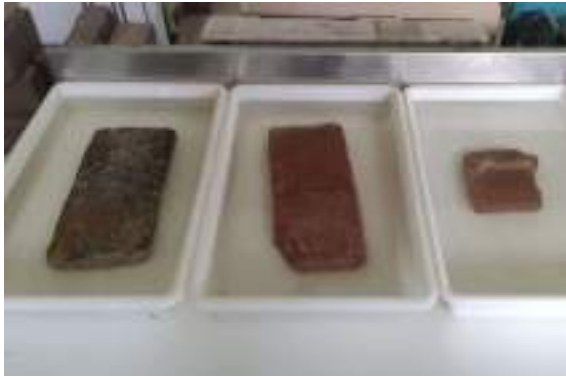
Fig. 140. Probetas de ladrillo sumergidas para saturarlas en las bandejas con agua, en el laboratorio de la ETSAVA. Imagen del autor.
