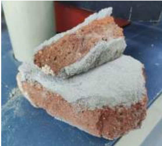
Fig. 145. Muestra de ladrillo 02 (mitad seca) tras pasar por la máquina de ensayo. Imagen del autor.
