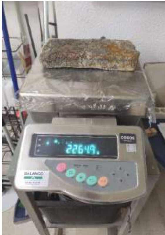
Fig. 142. Peso seco de la probeta 01 en la balanza de precisión (0,1 %). Imagen del autor.
