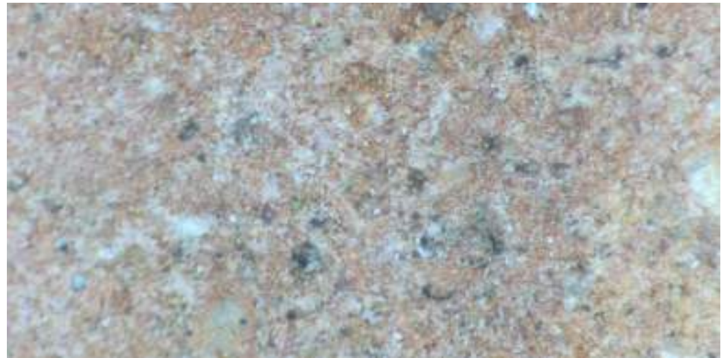
Fig. 126. Microfotografía del ladrillo 02 / aumento (x 2). Imagen del autor.
