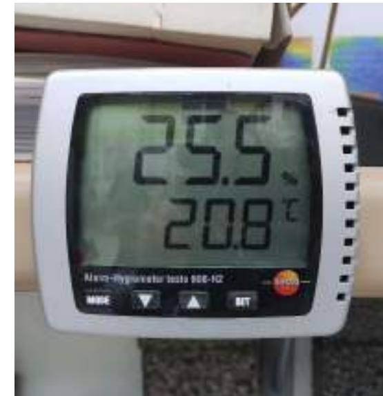
Fig. 139. Medidor de humedad y temperatura ambiente presente en el laboratorio de la ETSAVA. Imagen del autor.
