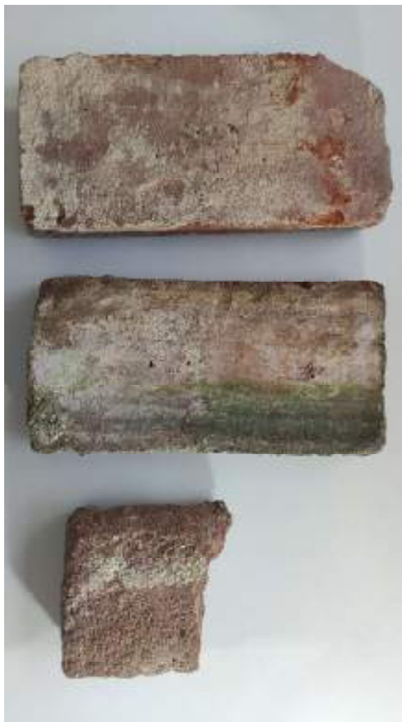
Fig. 101. Fotografía de los tres ladrillos de tejar recogidos para su estudio, durante la primera visita al castillo – palacio de Castronuevo, Ávila. Imagen del autor.
