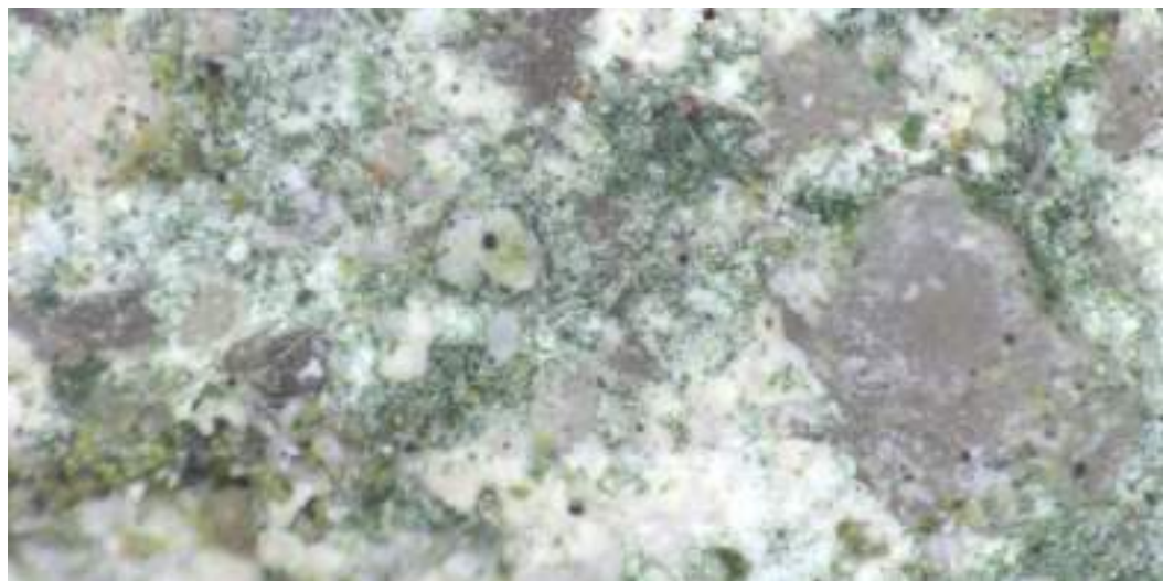
Fig. 121. Microfotografía del ladrillo 01 (restos de mortero)/ aumento (x 2). Imagen del autor.
