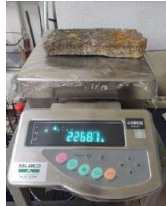
Fig. 137. Peso seco de la probeta 01 en la balanza de precisión (0,1 %). Imagen del autor.
