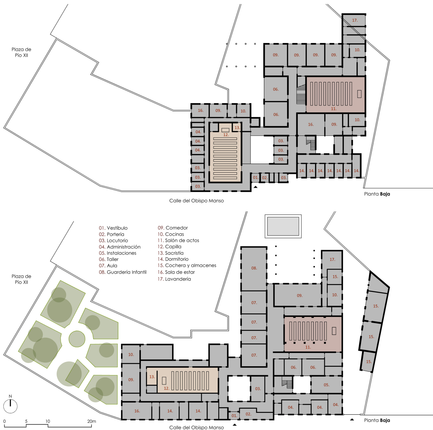
Fig. 188 Restitución del proyecto (superior) y la sede construida (inferior) del Patronato de Protección a la Mujer en Zamora.
