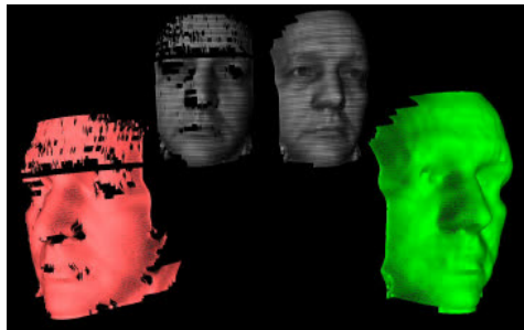
Figura 5.7: Efectos del ruido en la imagen adquirida. A la izquierda un modelo 3D con una gran cantidad de ruido. A la derecha, el mismo modelo después del proceso de la eliminación del ruido. [61]
