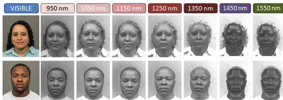
Figura 5.2: Imágenes faciales capturadas con una cámara NIR en diferentes longitudes de onda [42]
