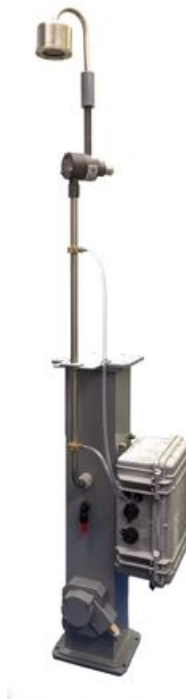
Figura 3.2: Nefelómetro IN102 de AirPhoton [19]
