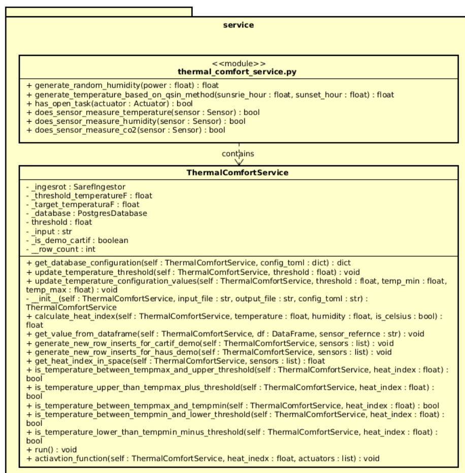
Figura 7.3: Diseño detallado del paquete service.
