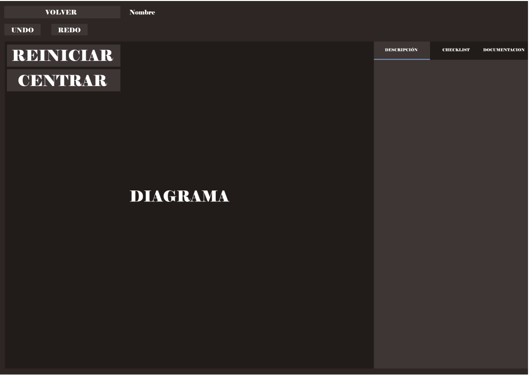
Figura 5.5: Vista del modo visualización. Se maximiza el espacio para renderizar el grafo y se mantiene un panel lateral para interactuar con el nodo activo.
