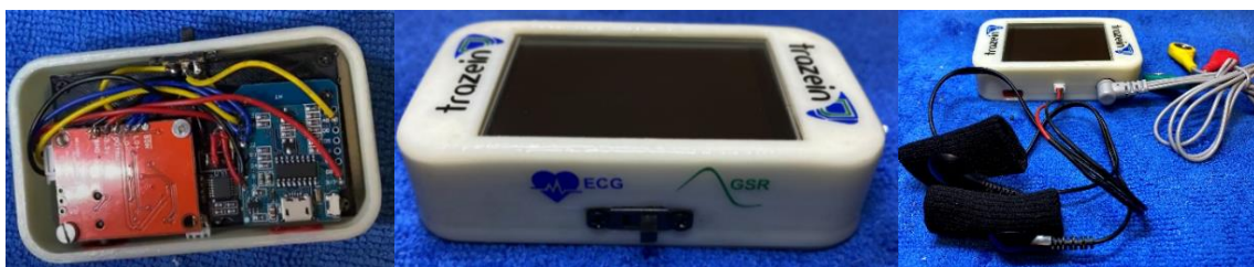
Figura 70 Dispositivo final impreso en 3D con sensores de ECG y GSR conectados
