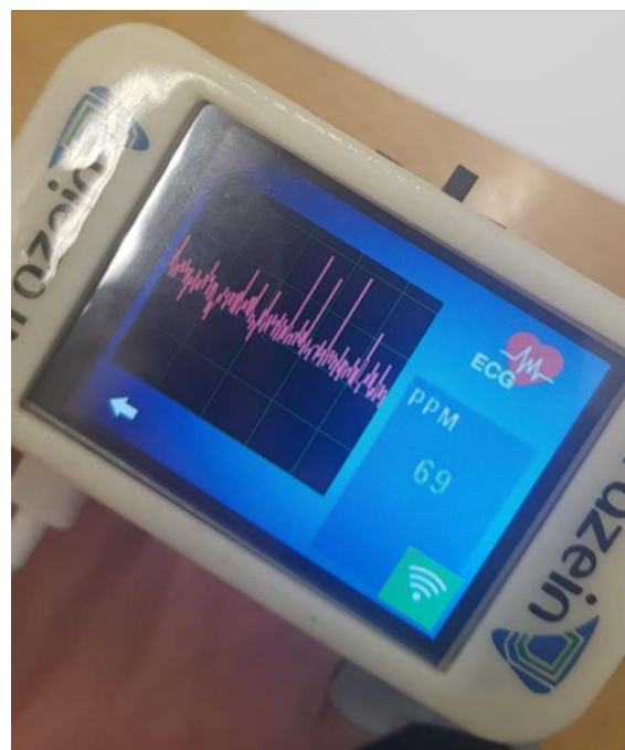
Figura 46 HMI Trazein mostrando la señal ECG y la medida BPM en tiempo real durante la adquisición de un sujeto
