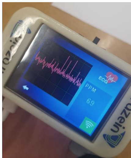
Figura 72 Dispositivo en funcionamiento mostrando la señal ECG y los BPM en reposo
