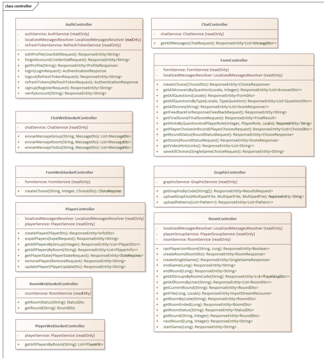
Figura 5.49: Esquema de clases de control de la versión modificada
