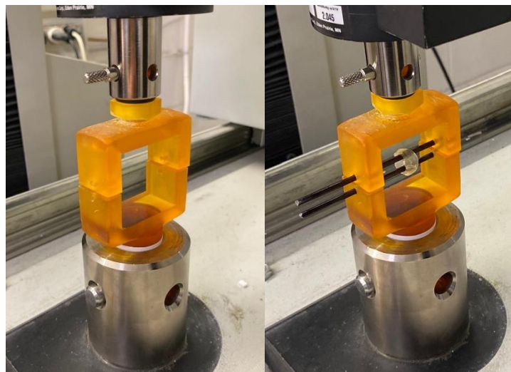
Figura 14. A la izquierda la pieza impresa colocada en la máquina, a la derecha el montaje completo con las barras y el hidrogel en medio. Fuente: elaboración propia.
