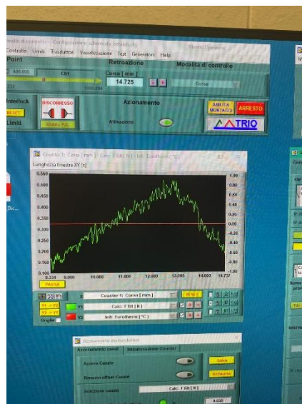
Figura 17. Gráfica que aparece por pantalla donde se ve el pico que indica la rotura de la muestra. Fuente: elaboración propia.
