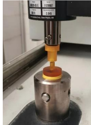
Figura 13. Montaje de la prueba de compresión. Fuente: elaboración propia.
