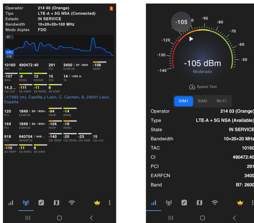
Figura 6. Ejemplo de la información de señal mostrada por la aplicación Netmonitor en dispositivo Android.
