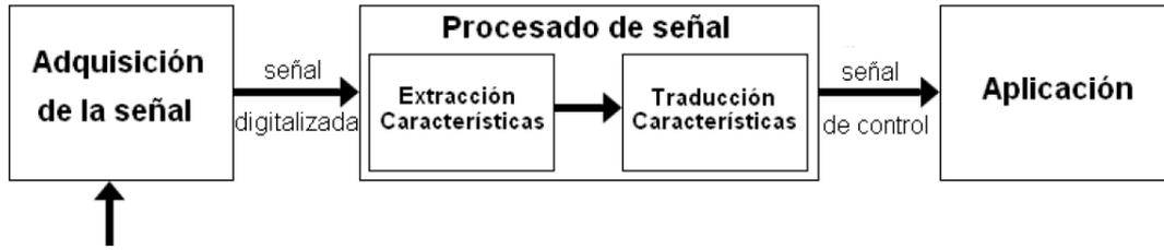
Figura 2.4: Esquema de las etapas de tratamiento de una señal en un BCI [14].
