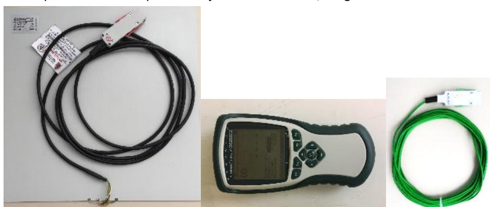
Figura 3.10. De izquierda a derecha: placa de flujo térmico, data logger y termopar.
