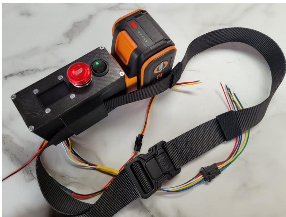
Figura 79. Montaje caja del cinturón de batería Foto propia.
