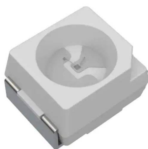
Figura 2.5: Sensor GUV A-S12SD sin encapsulado de módulo.
