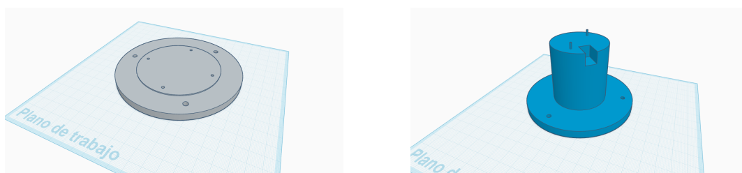
Figura 2.31: Soportes: veleta y anemómetro.
