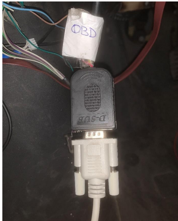
Figura 12. Conexión CAN entre OBD y PC Fusión mediante conector Sub-DB9
