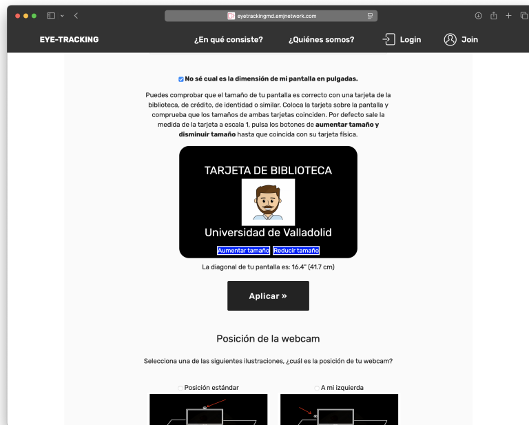
Figura C.3: Mecanismo de estimación del tamaño de la pantalla.
