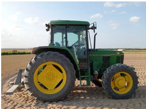
Figura 4.5. Tractor John Deere durante la prueba en dinámico con la antena de referencia en el bastidor
