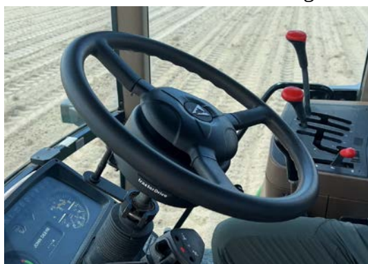
Figura 4.2. Motor del autoguiado tractorDrive que acciona el volante del tractor durante las pruebas de guiado.
