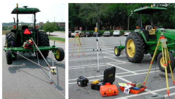
Figura 3.3. Plataforma utilizada para realizar las marcas en el suelo con tiza a distintas distancias del eje trasero del tractor y llevar la antena a 3.6 m de distancia del eje trasero del tractor (30).
