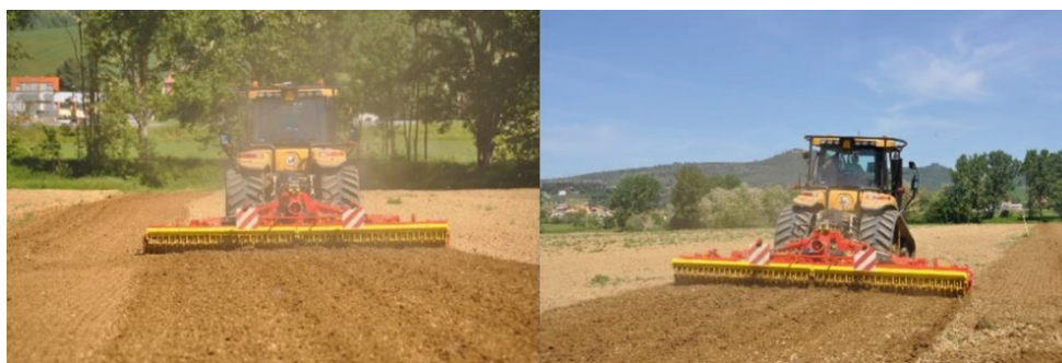
Figura 3.5. Pruebas arando manualmente a la izquierda y con autoguiado a la derecha.
