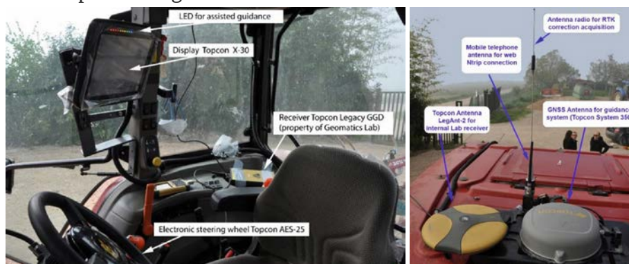
Figura 3.9. Sistema de guiado montado en el tractor y antenas montadas en la cabina.
